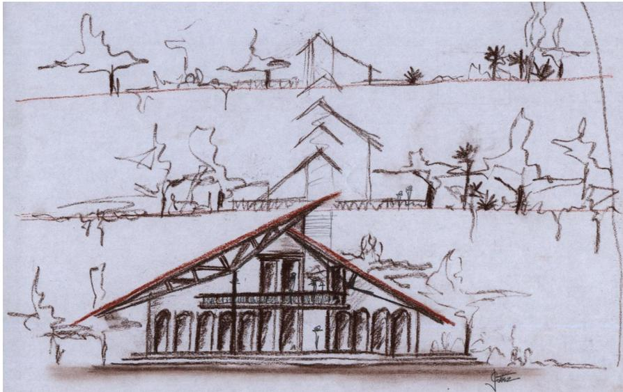
Figura 6– Variação da proposta em coberturas treliçada e elementos atirantados
