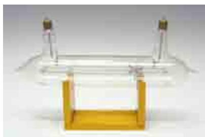
Figura 25 - Tubo de Crookes com montagem contendo catavento interno.
