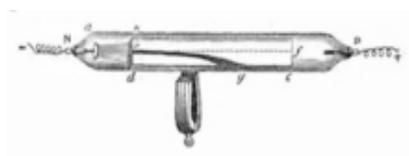
Figura 24 - Ampola de raios catódicos submetida a um campo magnético
