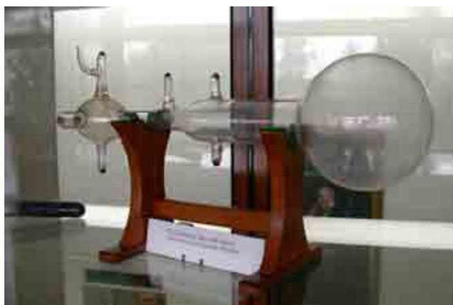
Figura 26 – Tubo original de raios catódicos empregado por Thomson para a determinação da relação carga/massa do elétron
