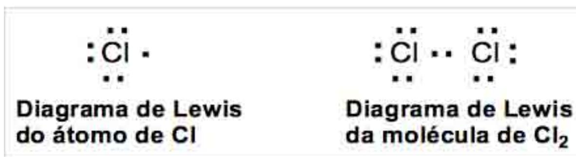
Pelo diagrama pode-se ver que cada átomo de cloro completa seu octeto pelo compartilhamento de um par de elétrons, satisfazendo assim a regra do octeto, e formando uma molécula estável  $\text{Cl}_2$ .
