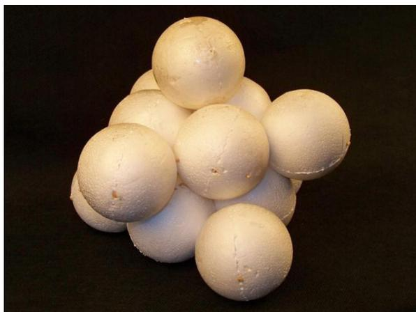
Figura 18 – Representação de três camadas de esferas em arranjo do tipo ABC.
