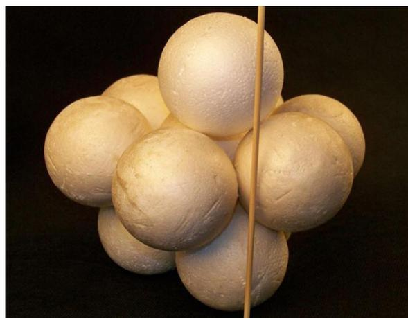
Figura 14 – Visão do arranjo mostrado na Figura 13, enfatizando o alinhamento das esferas da primeira e terceira camadas, típicas de um empilhamento do tipo ABA.
