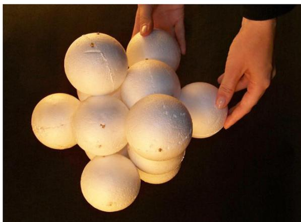
Figura 20 – Arranjo do tipo ABCA da Figura 19, mostrado em outro ângulo de visão. Mostrando duas faces do cubo de face centrada.
