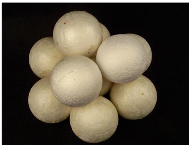
Figura 11 – Montagem do empacotamento denso de duas camadas de esferas do tipo AB.
