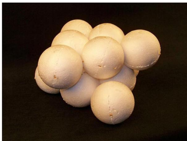
Figura 17 – Representação de duas camadas de esferas em empacotamento do tipo AB.
