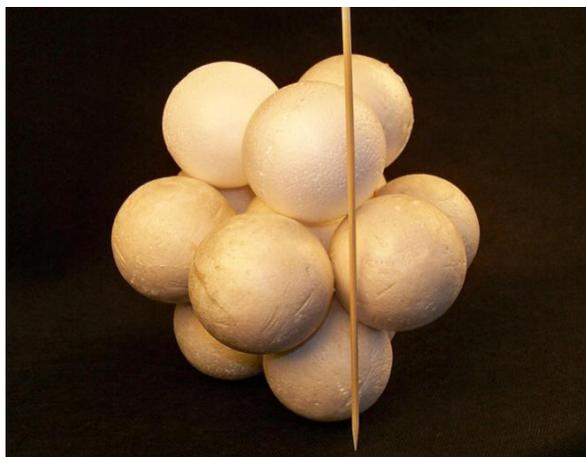
Figura 15 – Empacotamento denso de esferas do tipo ABA.
