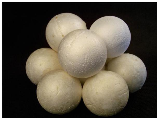
Figura 12 – Montagem de duas camadas de esferas AB mostrando a ocupação alternada dos interstícios da primeira camada pelas esferas da segunda camada.
