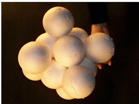
Figura 22 – Visão do arranjo ABCA mostrando uma face do cubo de face centrada.
