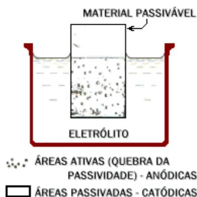
Figura 21 - Pilha Ativa-Passiva ([Fonte](#))
