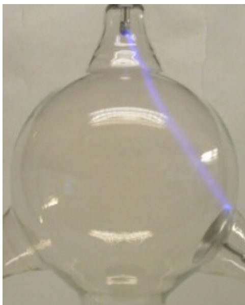
Ampola de Crookes em pressão alta
